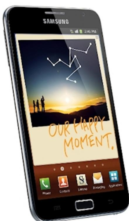
Компания Samsung Electronics анонсировала на выставке IFA новый Android смартфон Samsung Galaxy Note, ранее известный под кодовым названием Samsung Galaxy Q. Это производительное устройство с огромным для смартфона сенсорным дисплеем: его диагональ составляет 5,3 дюйма. При этом, экран впервые в мире выполнен по технологии HD SuperAMOLED и обладает высоким разрешением 1280x800 пикселей.
