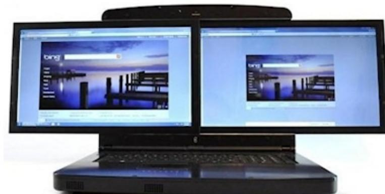
Ноутбук построен на процессорах Intel Core, оснащен дискретной графикой NVIDIA GeForce GT8 250M, до 8 ГБ оперативной памяти DDR 1333 МГц, 500 ГБ винчестером, оптическим приводом DVD, Gigabit Ethernet, Wi-Fi 802.11 b/g/n, Bluetooth 2.1, кардридером 6-в-1 и 6-элементным аккумулятором. Устройство заключено в корпус из магниевого сплава. Новинка выйдет в трех конфигурациях:
