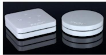
Устройство состоит из передатчика, который подключается к ПК через порт microUSB, и приемника (которых может быть несколько). Приемник может подключаться к стереосистеме через разъемы RCA или цифровой оптический выход. Таким образом, данные от передатчика до приемника проходят в цифровом виде, а последний выполняет цифро-аналоговое преобразование.
