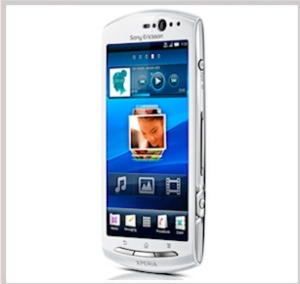
Трубка будет иметь 3,7-дюймовый сенсорный TFT-дисплей, в котором применены технологии Sony Ericsson «Reality Display» и «Mobile Bravia Engine» и четырехъядерный процессор Snapdragon MSM8255. Обещается 5-мегапиксельная камера с 16-кратным зумом и возможность записи HD-видео с разрешением 720p, а также дополнительная фронтальная камера для видеозвонков. Заявлено наличие порта HDMI.
