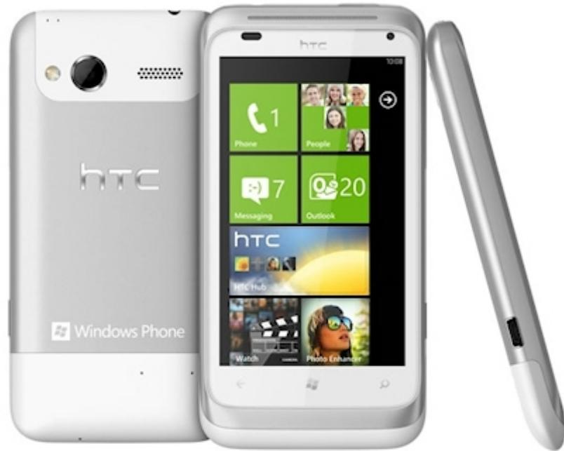
Новинка оборудована процессором Qualcomm Snapdragon MSM8255 SoC с частотой 1,5 Гц, имеет 512 МБ оперативной памяти, а диагональ экрана составляет 3,8 дюйма. Трубка оборудована основной 8-мегапиксельной камерой и фронтальной камерой для видеозвонков, причем обещается поддержка Skype.
