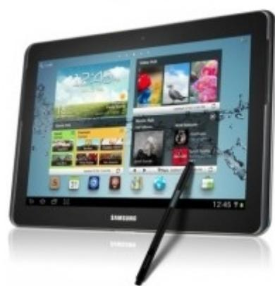
Основные отличия кроются в наличии того самого стилуса S-Pen, который как и в случае с "обычным" Galaxy Note, может быть использован для целого ряда специфических задач. Стилус является достаточно мощным инструментом — он позволяет передать не только прикосновение, но и силу нажатия и угол наклона пера, что делает его полезным инструментом для художников и дизайнеров.
